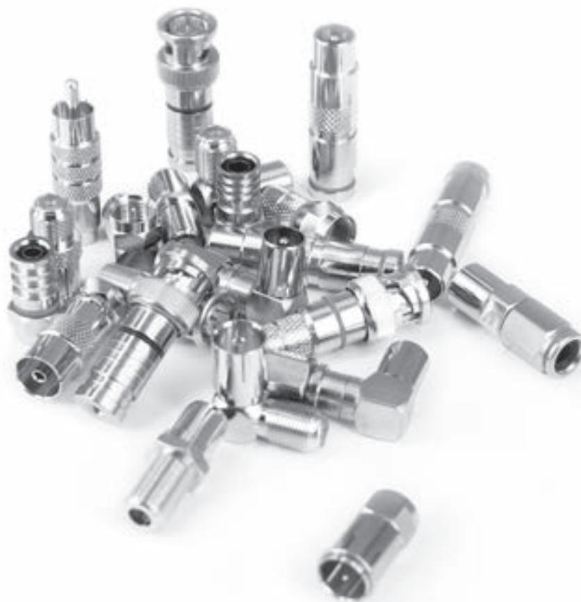
**Tutti i nostri connettori sono realizzati in ottone e protetti dagli agenti atmosferici per mezzo di un trattamento a base di solo nickel o nickel/stagno.** Entrambi questi trattamenti permettono di superare favorevolmente i test con nebbia salina.
