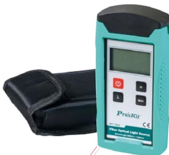
Sorgente luminosa a fibra ottica 850nm e 1300nm da utilizzare con l'articolo HS15-MESS. Nell'uso combinato queste unità servono a misurare l'attenuazione del collegamento di trasmissione in fibra multimodale.
