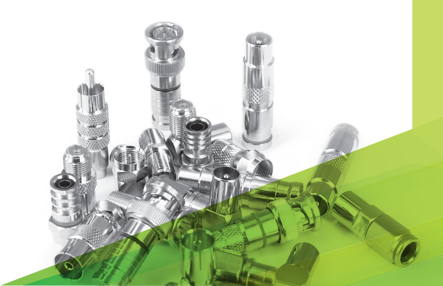
Tutti i nostri connettori sono realizzati in ottone e protetti dagli agenti atmosferici per mezzo di un trattamento a base di solo nickel o Nickel/Stagno (Nicolloy). Entrambe questi trattamenti permettono di superare favorevolmente i test con nebbia salina.
