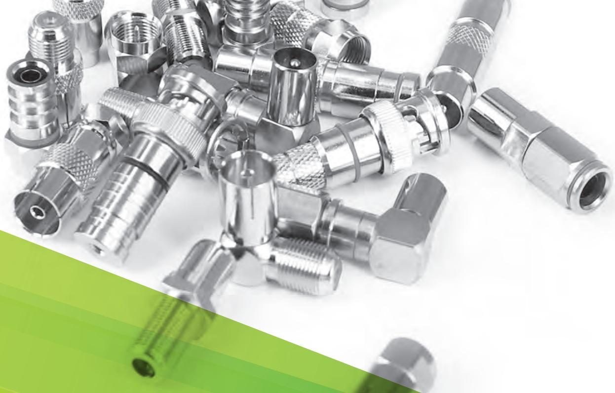
Tutti i nostri connettori sono realizzati in ottone e protetti dagli agenti atmosferici per mezzo di un trattamento a base di solo nickel o Nickel/Stagno. Entrambe questi trattamenti permettono di superare favorevolmente i test con nebbia salina.
