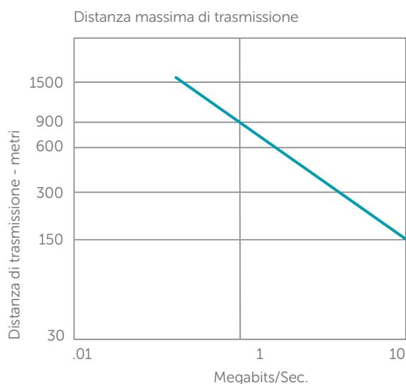
È una famiglia di prodotti che trova largo impiego nei collegamenti seriali multipunto (trasmissione dati) tra dispositivi di comunicazione che lavorano a una velocità di trasmissione massima di 10 Mbit/s. Sono disponibili cavi aventi sezione diversificate in base alle velocità di trasmissione e alla distanza da coprire. Esempio: per velocità di trasmissione inferiori a 90 kbit/s, la distanza è limitata a 1200 m, EIA raccomanda un cavo 24 AWG - 0,22 mm<sup>2</sup> - 52,5 pF/m.
