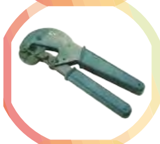
Pinza a crimpare HEX 0,324" - 0,475" Per connettori tipo F su cavi con diametro compreso fra 5 e 11 mm. art. HL98028830
